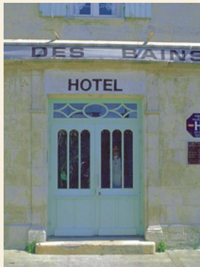
Employée pour la construction des murs en pleine maçonnerie ou en éléments (harpes, moulures, corniches, bandeaux) la pierre de taille calcaire doit rester apparente et n'être ni peinte, ni enduite.
