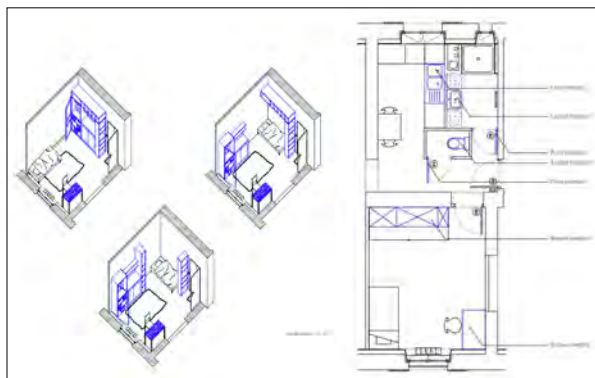
Les sites démonstrateurs du projet CHARM - Caserne Exelmans Paris 16 - Réemploi et modularité des meubles (CHU et Pension de Famille) - Prototypage de meubles en réemploi réalisés à partir de portes palières
